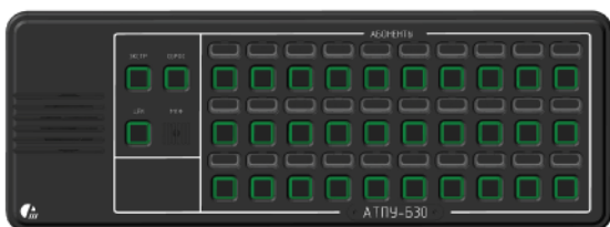
ПУЛЬТОВАЯ ПАНЕЛЬ УПРАВЛЕНИЯ АБОНЕНТСКИМ ТЕРМИНАЛОМ НА 16 НАПРАВЛЕНИЙ;
