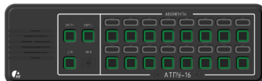
ПУЛЬТОВАЯ ПАНЕЛЬ УПРАВЛЕНИЯ АБОНЕНТСКИМ ТЕРМИНАЛОМ НА 30 НАПРАВЛЕНИЙ.
